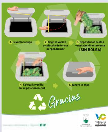
Con el objetivo de facilitar a los vecinos el depósito de los restos de poda en los contenedores ubicados en la vía pública, el consistorio ha instalado en ellos un sistema de sujeción de tapa que permite al ciudadano depositar los residuos vegetales de una manera más cómoda. Consiste en la instalación de una varilla que permite mantener la tapa del contenedor abierta sin necesidad de sujetarla con la mano.
