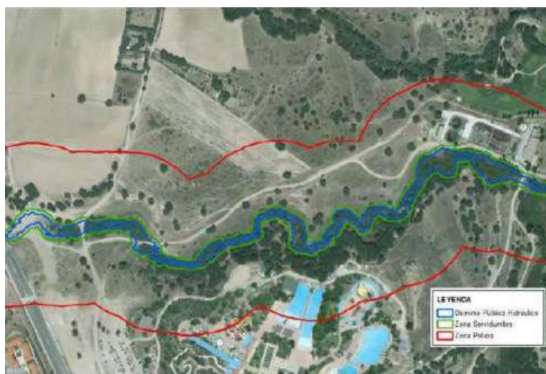
Figura 3: Dominio público hidráulico, zona de servidumbre y zona de policía del arroyo Pedro Elvira en el tramo donde se sitúa la EDAR (Fuente: Documentación presentada)
