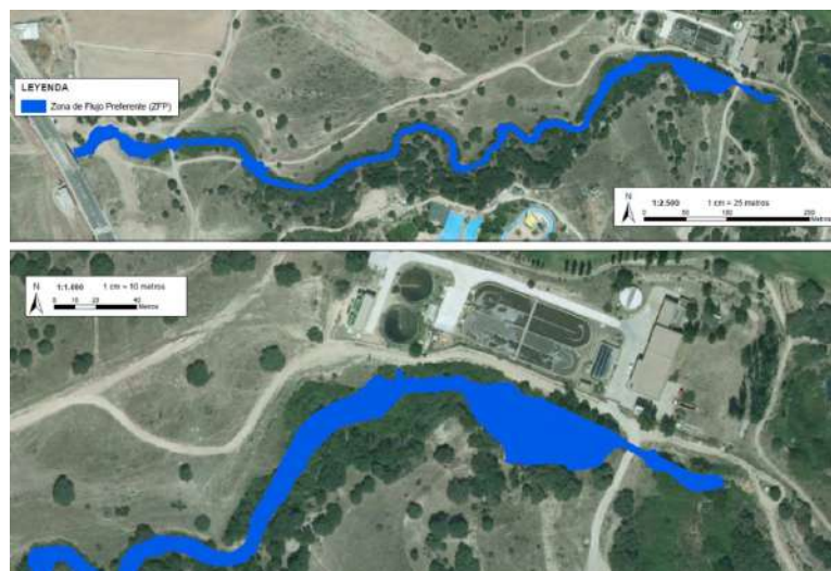
Figura 4. Zona de flujo preferente del arroyo de Pedro Elvira (Fuente: Documentación aportada)
